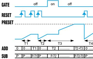
Inp A: Keine Funktion / Inp B: Keine Funktion Zeitzählbefehl über Reset (manuell oder elektrisch) / Addieren: Display 0 → Voreinstellung / Subtrahieren: Display Voreinstellung → 0 Gate-Eingang mit Display-Memory-Funktion
