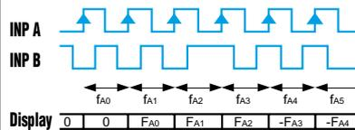
Inp A: Frequenzeingang 1 / Eing. B: Frequenzeingang 2 Formel: A + B
