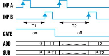
Inp A: Keine Funktion / Inp B: Ein/Aus Individuelle Zeitzählung während B aktiv, automatisches Zurücksetzen vor jeder neuen Zählung / Addieren: Display 0 → Voreinstellung / Subtrahieren: Display Voreinstellung → 0
