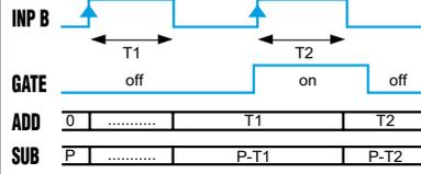
Inp A: An / Eing. B: Aus Kumulative Zeitzählung / Addieren: Display 0 → Voreinstellung / Subtrahieren: Display Voreinstellung → 0
