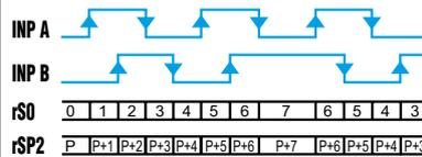
A 90 ° B Inp A: Zählereingang Zählen auf eine steigende Flanke und auf eine fallende Flanke / Inp B: Richtungsumkehr / rS0: Display 0 → Voreinstellung / rSP2: Display Voreinstellung → 0
