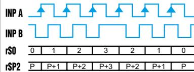
Inp A: Zus. Zählereingang 1 / Eing. B: Sous.-Zählereingang / 2 rS0: Display 0 → Voreinstellung
