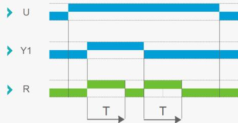
**Funktion C: Rückfallverzögerung mit Hilfsspannung**
