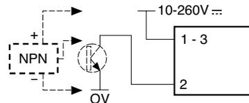
Entrada de arranque/parada o reinicio: Sensor de proximidad de 2 hilos R=470  $\Omega$ /2 W para detector de corriente de fuga de 2 hilos  $\leq$  1 mA
