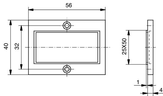
26546844 - Adaptador para recorte de 50 x 25 mm - Fijado con clips
