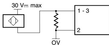
Entrée de démarrage/arrêt ou réinitialisation: Capteur de proximité 2 fils R=470  $\Omega$ /2 W pour détecteur de courant de fuite 2 fils  $\leq$  1 mA
