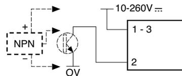
Entrée de démarrage/arrêt ou réinitialisation : Capteur de proximité 2 fils R=470 Ω/2 W pour détecteur de courant de fuite 2 fils ≤ 1 mA
