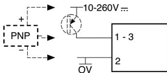
Compteur, transistor NPN d'entrée de démarrage/arrêt, réinitialisation ou capteur de proximité PNP à 3 fils (pour détecteur de courant de fuite < 1 mA)
