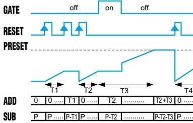
Inp A : Aucune fonction / Inp B : Pas de fonction Commande de comptage du temps via Reset (manuel ou électrique) / Ajouter : Affichage 0 → Préréglage / Soustraire : Affichage Préréglage → 0 L'entrée Gate dispose d'une fonction de mémoire d'affichage
