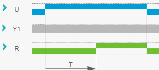
Fonction Ac : Temporisé à la mise sous tension et à la coupure avec signal de commande
