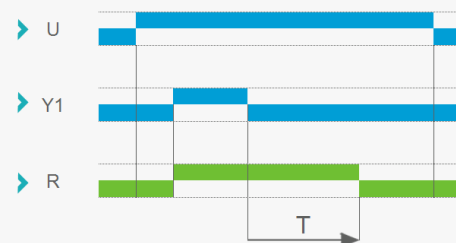
Fonction D : Clignotant à cycle symétrique (départ OFF)
