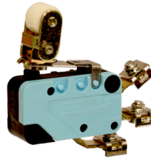
Levier à galet escamotable (actif coté droit, inactif coté gauche)
