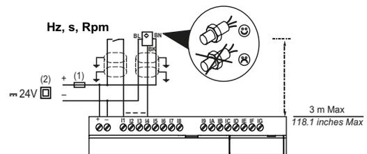
(1) Fusibile rapido da 1 A (UL248) interruttore o protettore di circuito (US)
